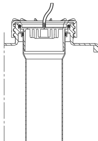
Abb. 5 Schraubdeckel mit Schlauch und Staudruckrohr DN 100
