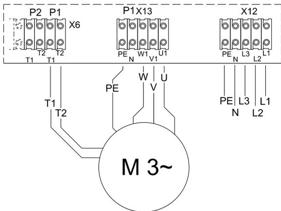
Abb. 26 Schaltplan für dreiphasige Multilift M.12.3.4 und M.15.3.4
