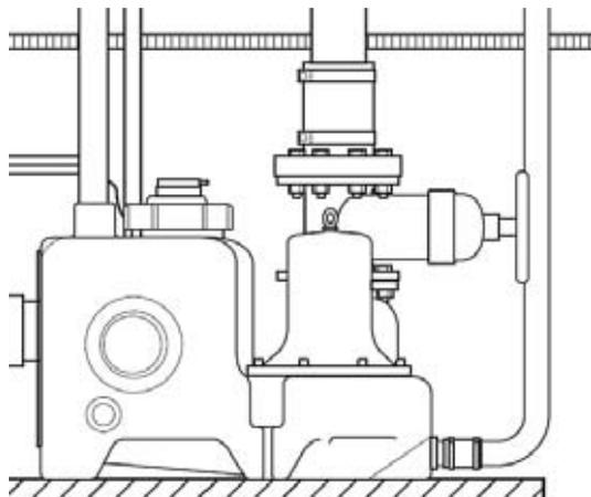
Abb. 22 Absperrventil oben am Rückflussverhinderer
