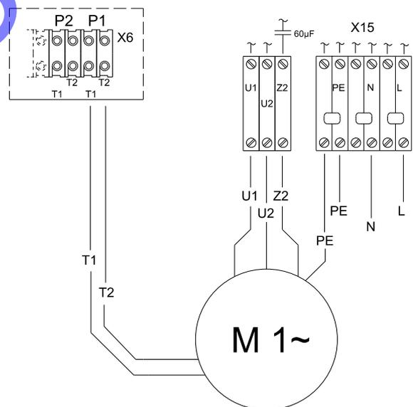
Abb. 25 Schaltplan für einphasige Multilift M.12.1.4 und M.15.1.4
