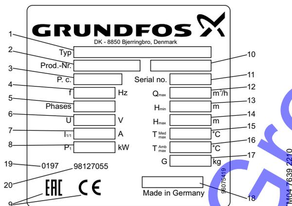
Abb. 2 Typenschild der Hebeanlage
