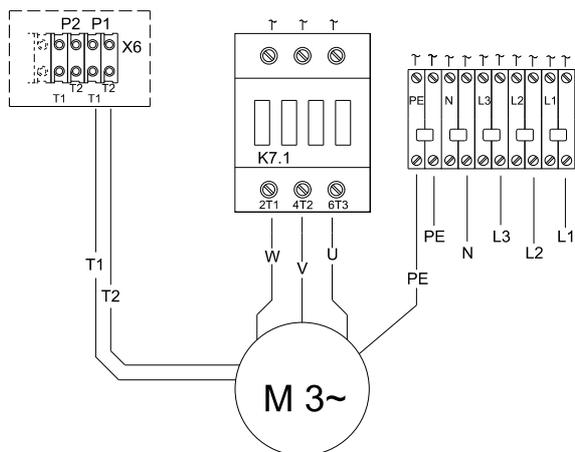
Abb. 27 Schaltplan für dreiphasige Multilift M.22.3.4 mit Schaltschütz
