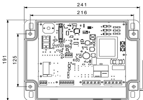
Abb. 15 Anbringen der Steuerung an der Wand
