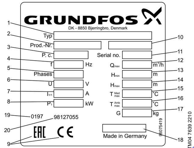
Abb. 2 Typenschild der Hebeanlage
